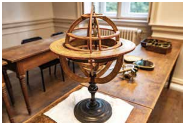
La sphère armillaire, instrument servant à modéliser la sphère céleste.
